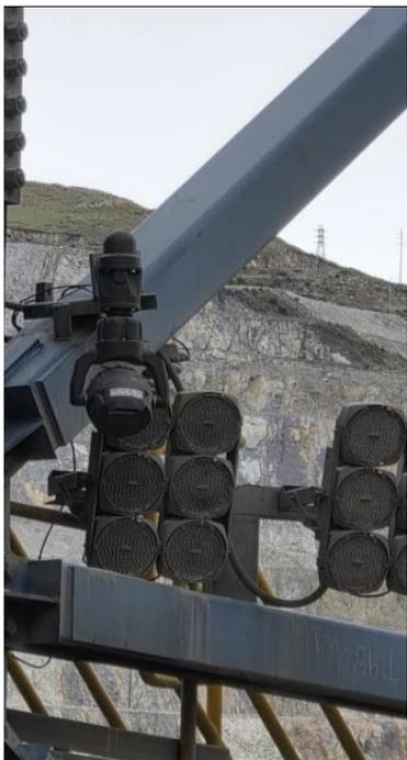
**Figura 4. Cámara PTX con luminarias y micrófono**
