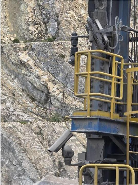
**Figura 3. Cámaras PTZ y fija pica rocas 1**
